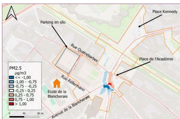
Carte de différence des concentrations de PM2.5 en moyenne annuelle avec/sans réaménagement en 2030 (le périmètre des réaménagements délimité en pointillé orange).
